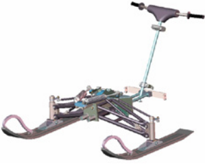
Şekil 6: Motorlu kızağın ön süspansiyonu yaylar ve sönümlendiriciler içeren çok sayıda bağlantıdan oluşur.
